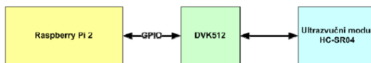
Слика 2.5 Блок шема ултразвучног мерача растојања
